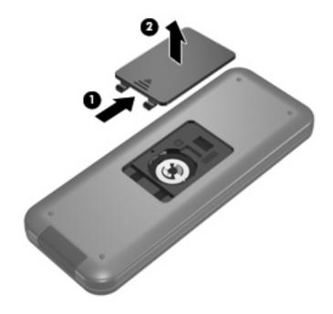
2. バッテリを、プラス(+)面を上に向けてコンパートメントに装着します(1)。
