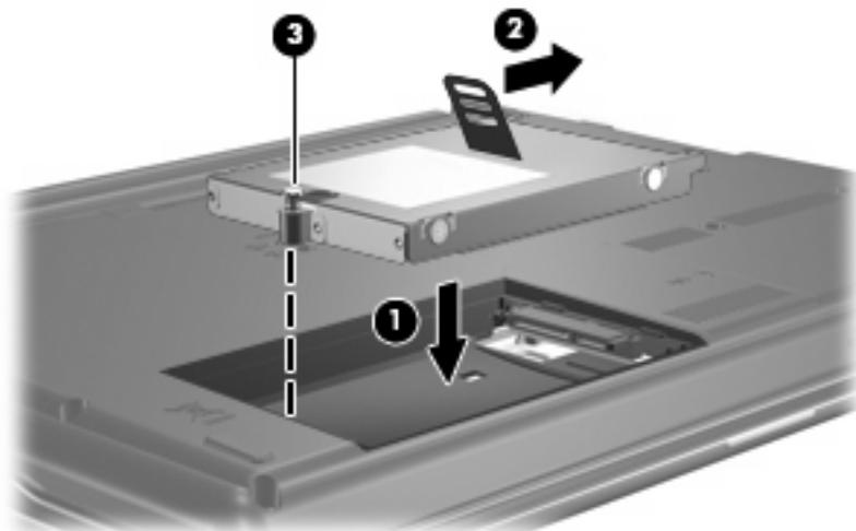
4. 将硬盘驱动器盖上的卡舌 (1) 对准笔记本计算机上的相应槽口。
