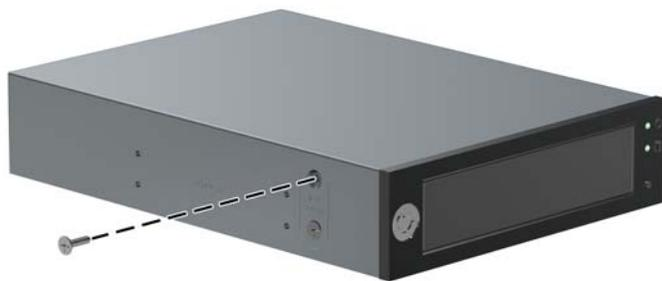
2. クイック リリース システムを使用して、オプティカル ドライブ ベイに DX115 ユニットを取り付けます。
