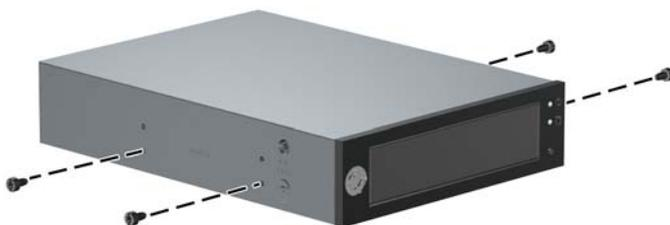
2. クイック リリース システムを使用して、オプティカルドライブベイに DX115 ユニットを取り付けます。
