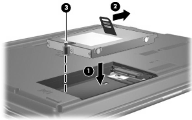
4. 将硬盘驱动器盖上的卡舌 (1) 对准笔记本计算机上的相应槽口。
