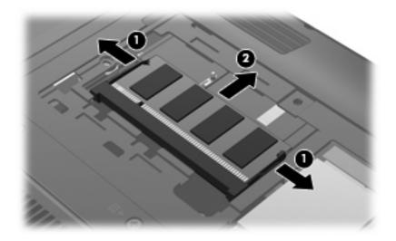
将取出的内存模块放入防静电的包装中,以保护内存模块。
