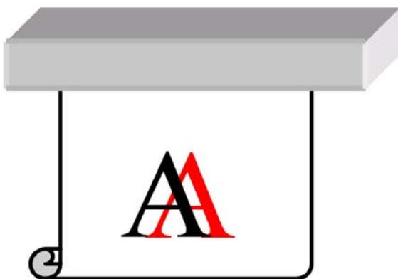
1. Stellen Sie sicher, dass das Druckmaterial nicht schräg eingezogen wird. Legen Sie das Druckmaterial ggf. neu ein, um den Schräglauf zu korrigieren.
