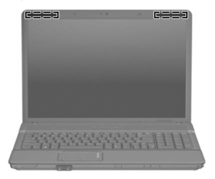
HINWEIS: Achten Sie im Sinne einer optimalen Übertragung darauf, dass sich keine Gegenstände in unmittelbarer Umgebung der Antennen befinden.
