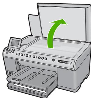
2. Cargue el original con la cara de impresión hacia abajo en la esquina frontal derecha del cristal.
