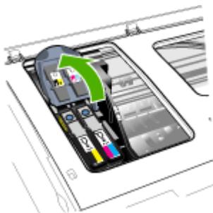
4. Angkat pegangan printhead (sesuai dengan pesan panel kontrol) dan gunakan untuk menarik printhead keluar dari slotnya.
