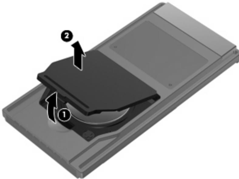
2. 배터리 양극이 위로 오게 하여 배터리 함에 넣습니다 **(1)**.
