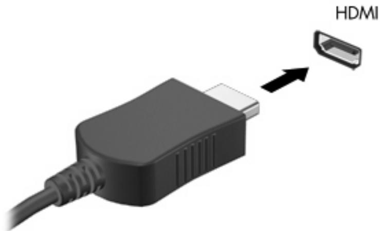
2. 根據裝置製造商的指示，將纜線的另一端連接到視訊裝置。
