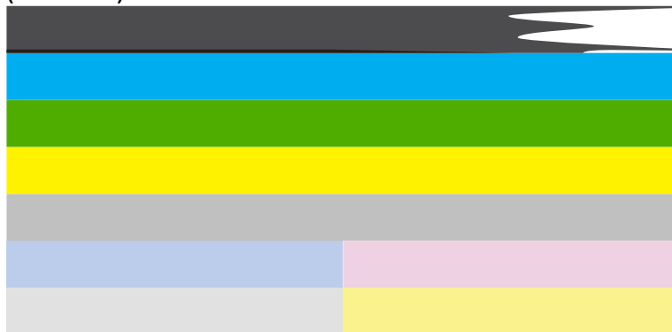
Obrázek 13-11 Barevné čáry - nepravidelné pruhy nebo vybledlá čára (horní čára)
