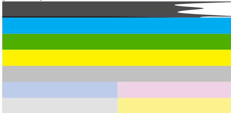
Obrázek 13-20 Barevné čáry - nepravidelné pruhy nebo vybledlá čára (horní čára)
