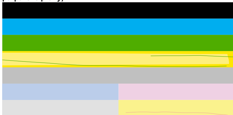
Obrázek 13-30 Barevné čáry - smíchání barev (žlutá čára obsahuje purpurové pruhy)
