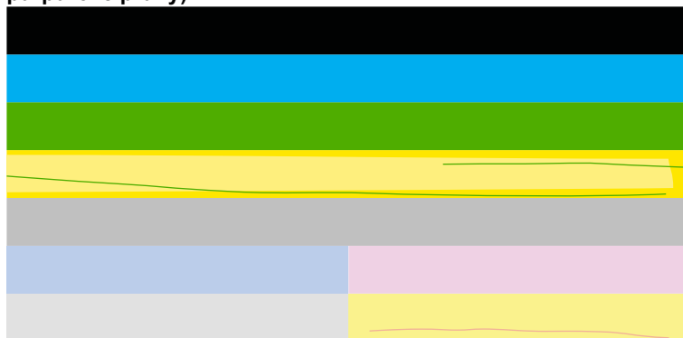
Obrázek 13-12 Barevné čáry - smíchání barev (žlutá čára obsahuje purpurové pruhy)
