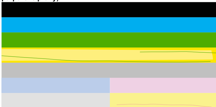
Obrázek 13-39 Barevné čáry - smíchání barev (žlutá čára obsahuje purpurové pruhy)
