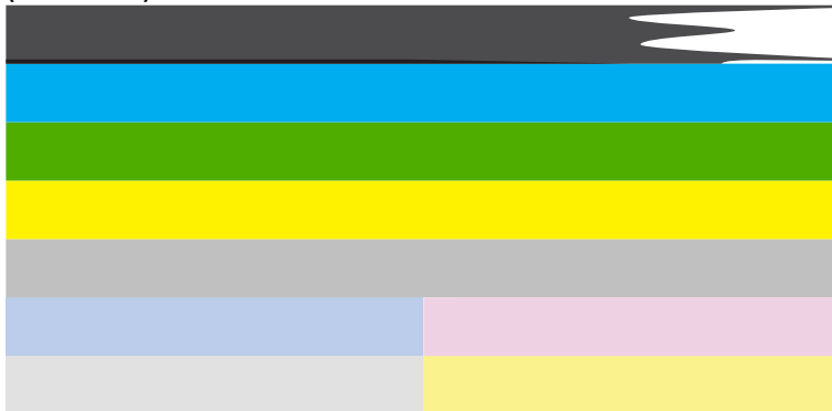
Obrázek 13-38 Barevné čáry - nepravidelné pruhy nebo vybledlá čára (horní čára)
