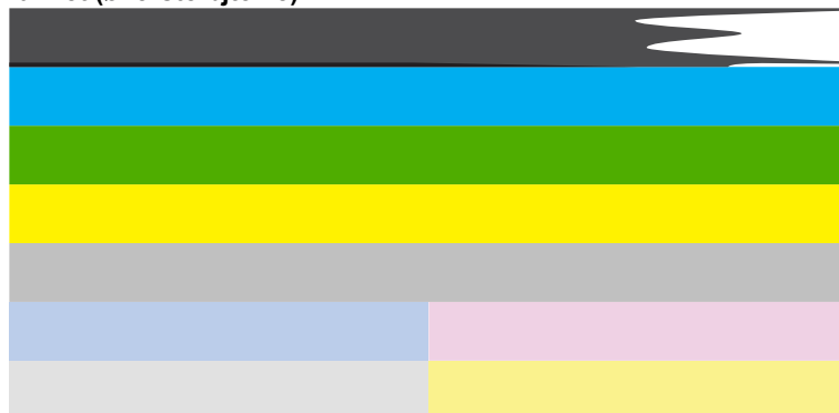
Figur 13-11 Farvebjælker - bjælke med uregelmæssige streger eller falmet (øverste bjælke)
