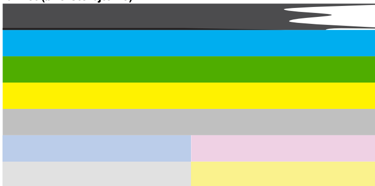
Figur 13-38 Farvebjælker - bjælke med uregelmæssige streger eller falmet (øverste bjælke)
