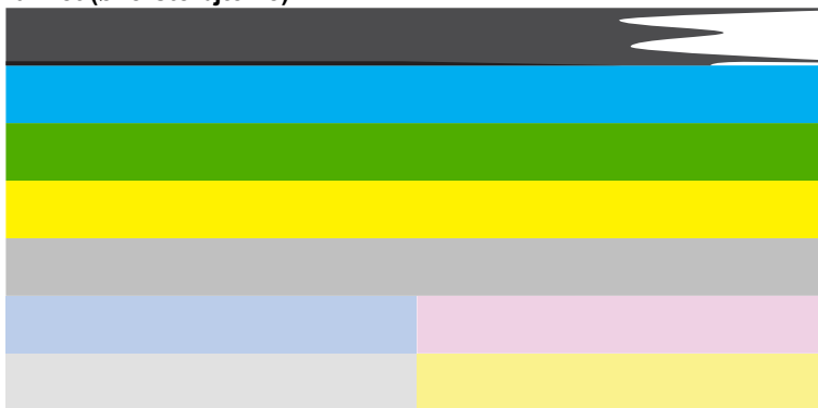
Figur 13-20 Farvebjælker - bjælke med uregelmæssige streger eller falmet (øverste bjælke)
