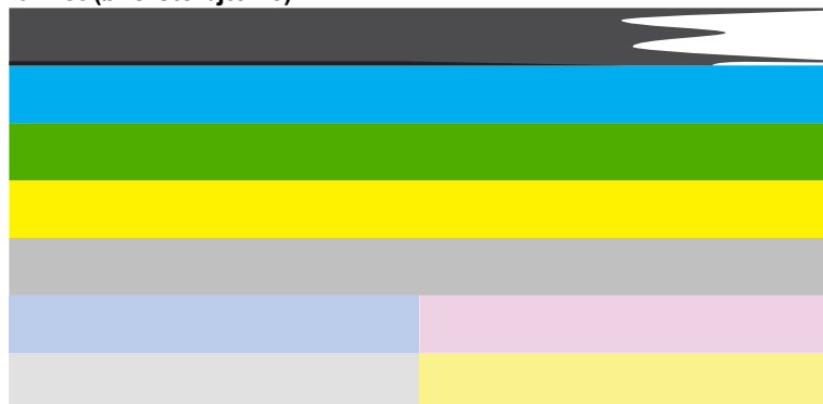
Figur 13-29 Farvebjælker - bjælke med uregelmæssige streger eller falmet (øverste bjælke)
