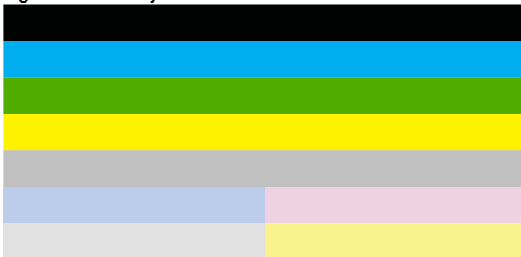
Figur 13-37 Farvebjælker - forventet resultat
