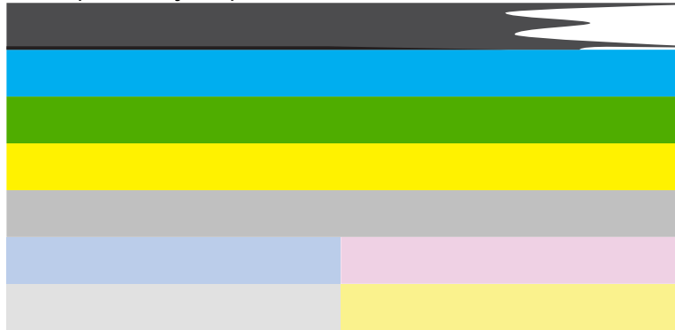
Figur 13-2 Farvebjælker - bjælke med uregelmæssige streger eller falmet (øverste bjælke)
