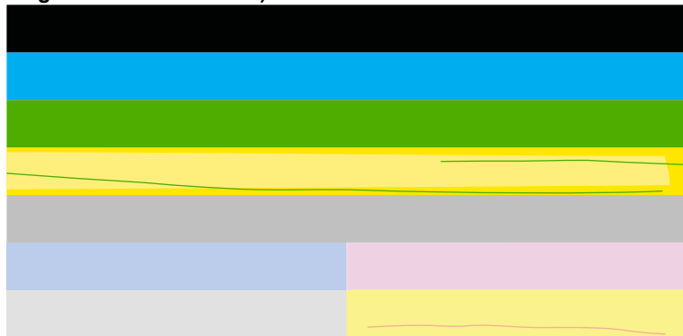
Abbildung 13-3 Farbbalken - Farbvermischung (gelber Balken enthält magentafarbene Streifen)
