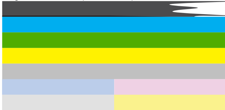
Abbildung 13-11 Farbbalken - unregelmäßige Streifen oder ausgebleicher Balken (oberer Balken)
