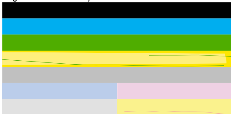
Abbildung 13-12 Farbbalken - Farbvermischung (gelber Balken enthält magentafarbene Streifen)
