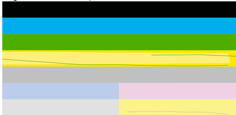
Abbildung 13-21 Farbbalken - Farbvermischung (gelber Balken enthält magentafarbene Streifen)
