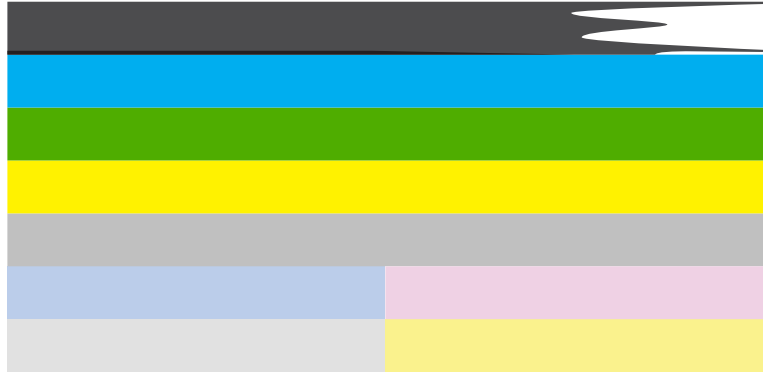
Abbildung 13-20 Farbbalken - unregelmäßige Streifen oder ausgebliehener Balken (oberer Balken)
