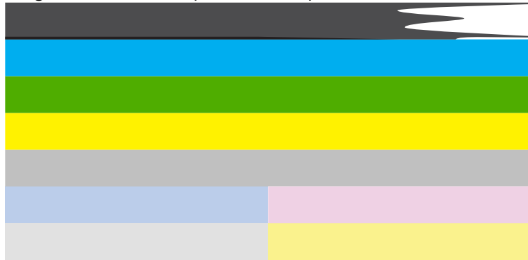
Abbildung 13-2 Farbbalken - unregelmäßige Streifen oder ausgebleicher Balken (oberer Balken)
