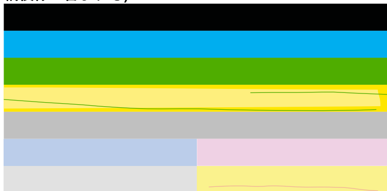
図 13-30 カラーバー - 色の混合 (イエローバーにマゼンタの縞模様が含まれる)
