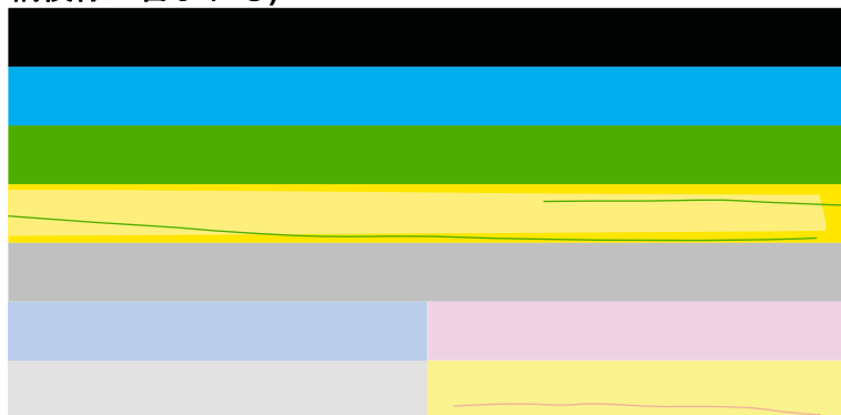
図 13-12 カラーバー - 色の混合 (イエローバーにマゼンタの縞模様が含まれる)
