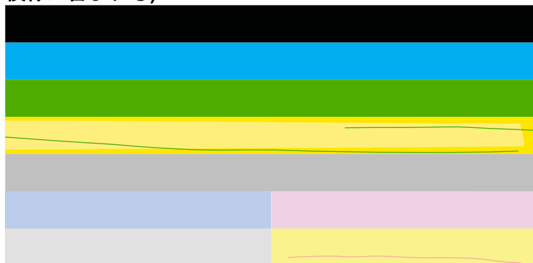
図 13-3 カラー バー - 色の混合 (イエロー バーにマゼンタの縞模様が含まれる)
