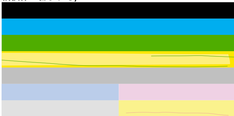
図 13-39 カラーバー - 色の混合 (イエローバーにマゼンタの縞模様が含まれる)
