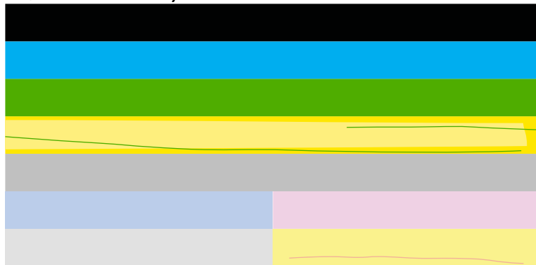
図 13-21 カラーバー - 色の混合 (イエローバーにマゼンタの縞模様が含まれる)
