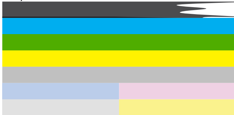
図 13-20 カラーバー - 不規則な縞模様またはかすれ (一番上のバー)
