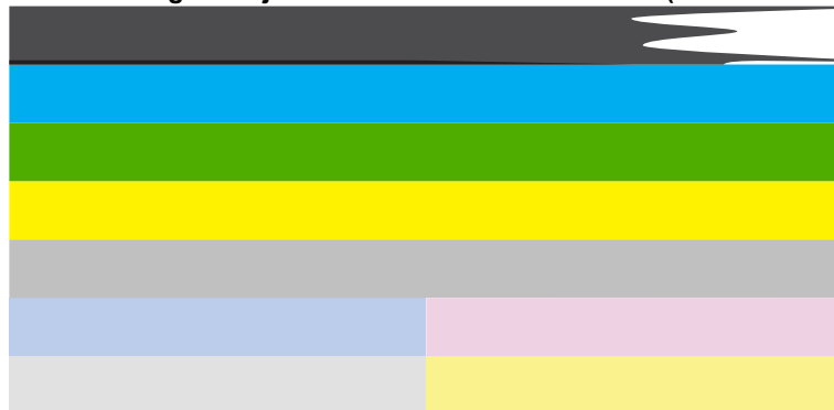
Bild 13-2 Färgfält - ojämnt strimmat eller urblekt fält (översta fältet)
