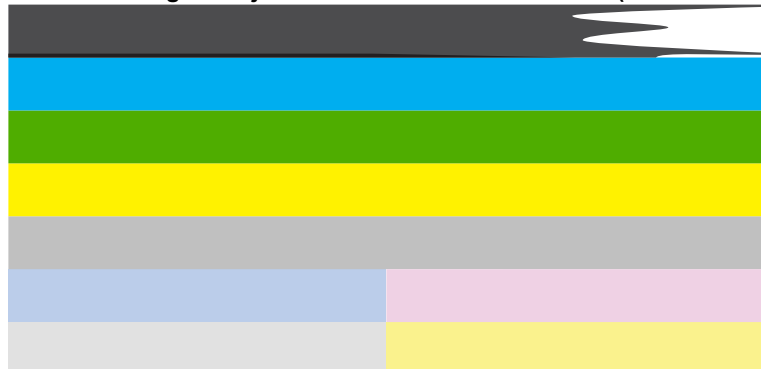
Bild 13-38 Färgfält - ojämnt strimmat eller urblekt fält (översta fältet)
