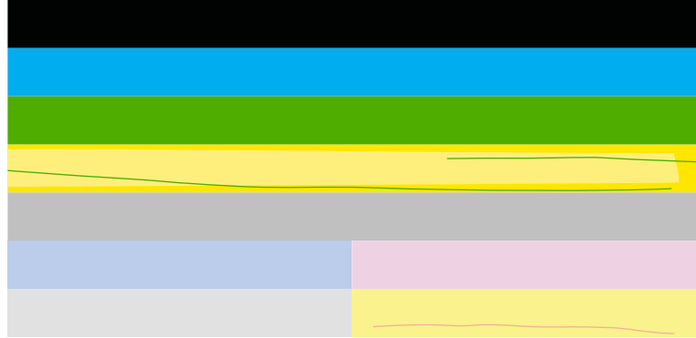
Bild 13-3 Färgfält - färgblandning (gula fält innehåller magentafärgade strimmor)
