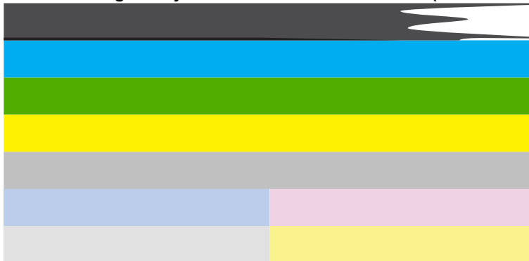
Bild 13-11 Färgfält - ojämnt strimmat eller urblekt fält (översta fältet)
