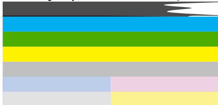
Bild 13-20 Färgfält - ojämnt strimmat eller urblekt fält (översta fältet)
