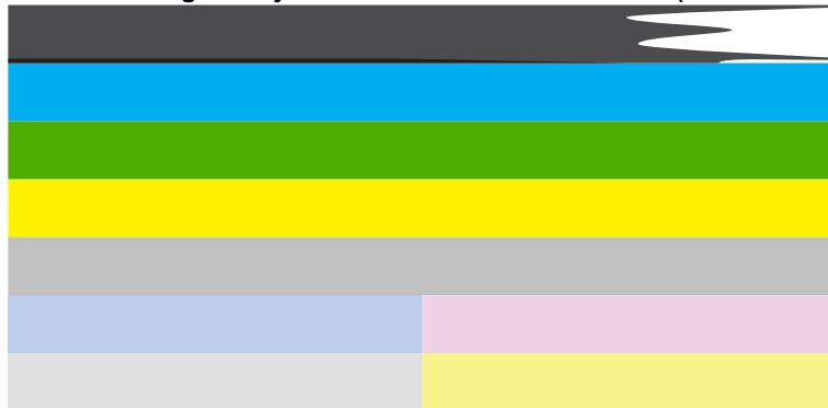
Bild 13-29 Färgfält - ojämnt strimmat eller urblekt fält (översta fältet)
