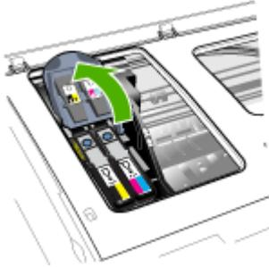
5. Heben Sie den Griff an dem Druckkopf an, den Sie austauschen möchten, und ziehen Sie dann den Druckkopf aus der Halterung.
