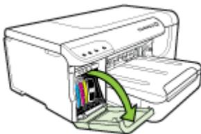
2. Entnehmen Sie die verbrauchte Tintenpatrone, indem Sie sie mit Daumen und Zeigefinger nach oben herausziehen.
