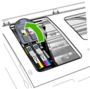
4. Heben Sie den Griff des Druckkopfs an und verwenden Sie ihn, um den Druckkopf aus seinem Schacht zu ziehen.
