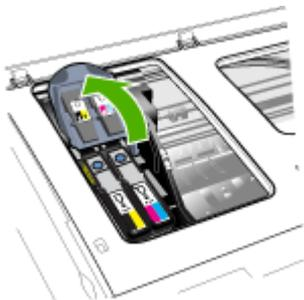
5. Heben Sie den Griff des Druckkopfs an und verwenden Sie ihn, um den Druckkopf aus seinem Schacht zu ziehen.
