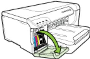
3. Retire los cartuchos de tinta de sus ranuras sujetándolos con los dedos pulgar e índice y tírelos firmemente hacia usted.
