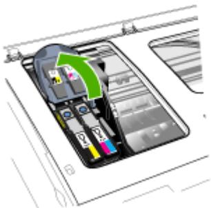
5. Levante el asa del cabezal de impresión que desea cambiar y luego sáquelo de la ranura.
