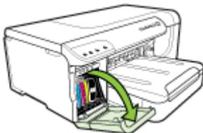
2. Para retirar el cartucho de tinta que debe ser reemplazado, sujételo con los dedos pulgar e índice y jale firmemente hacia usted.
