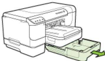
2. Deslice las guías del sustrato de impresión hasta la configuración más ancha.
