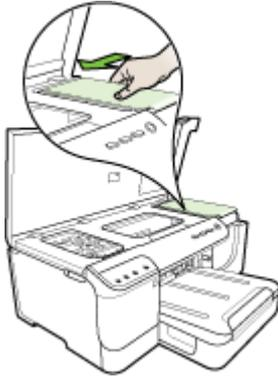
7. Después de que la impresora esté en reposo y el carro de impresión haya vuelto a su posición, pulse el botón **Encendido** para apagar el dispositivo.
