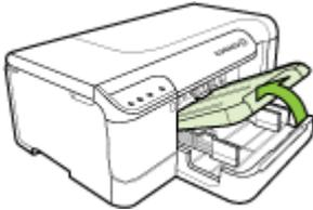
2. Deslice las guías del sustrato de impresión hasta la configuración más ancha.
