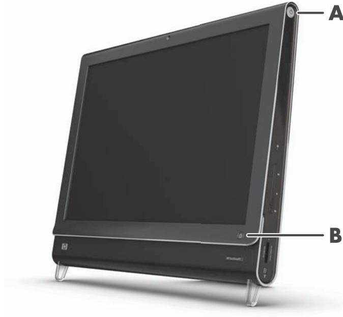
您可以按下鍵盤或遙控器上的「電源 / 睡眠」按鈕，將 HP TouchSmart PC 開機或讓電腦進入睡眠模式。僅有部份型號隨附遙控器。
