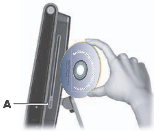
若要退出光碟，請先確定電源開啓，然後按下光碟機旁的退出按鈕 **(A)**。您也可以點選 Windows Vista [開始] 按鈕、[電腦]，按住（或用滑鼠右鍵按一下）CD 光碟機，然後點選 [退出]。
