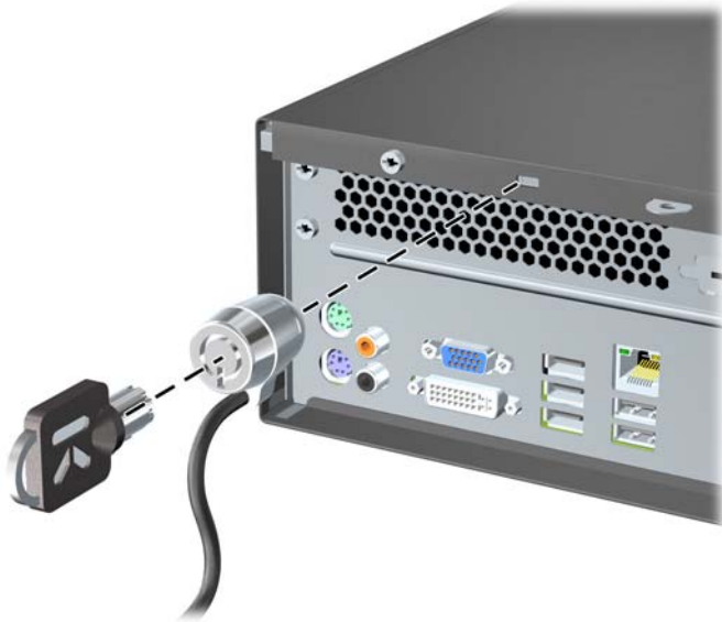
圖示 C-1 安裝纜線鎖
