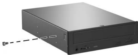
圖示 2-23 將導引螺絲鎖入光碟機
