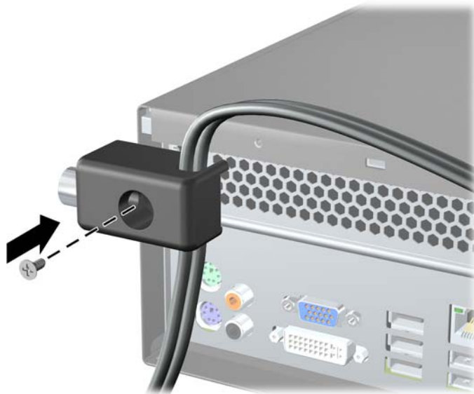
圖示 C-5 將鎖安裝到機箱
