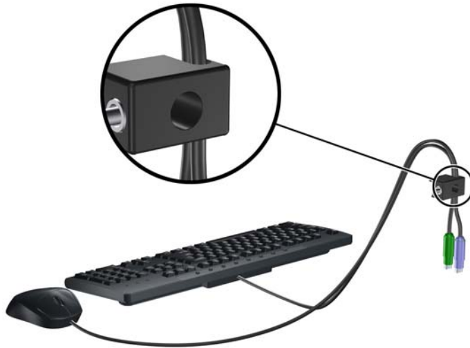
圖示 C-4 穿過鍵盤及滑鼠纜線
