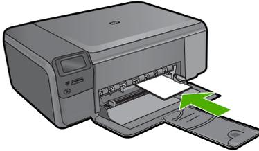
3. Deslice la guía de ancho del papel hacia dentro hasta que entre en contacto con el borde del papel.
