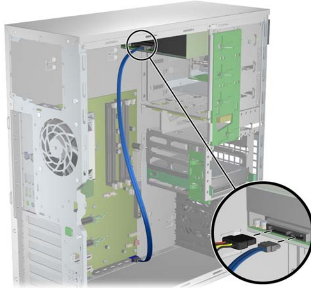
Figure 10-2 Connexion du câble d'alimentation du lecteur magnéto-optique pour disques et des câbles de données
