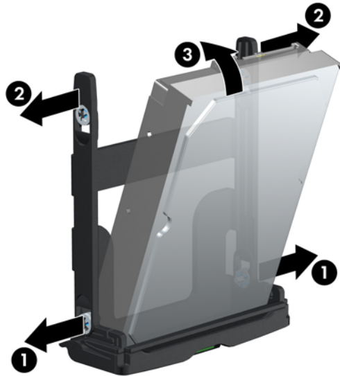
Figure 9-5 Installation du lecteur dans son support
