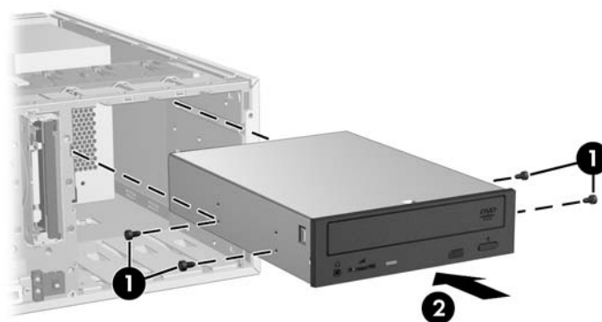
Figure 10-3 Installation du lecteur magnéto-optique pour disques
