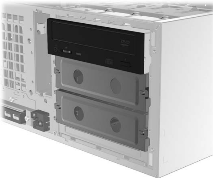
Figure 3-7 Réinstallation d'un lecteur magnéto-optique pour disques
