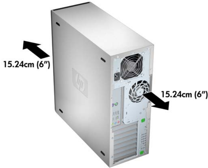
Şekil 3-1 İş istasyonunun doğru havalandırılması
