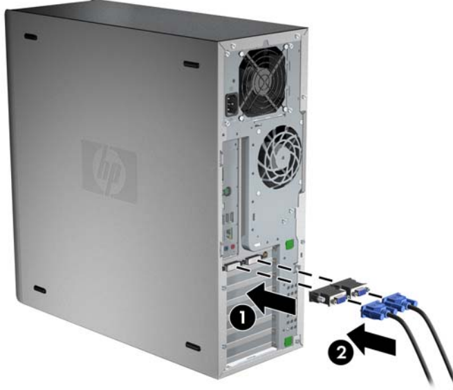
Şekil 3-8 Kabloları iş istasyonuna bağlama
