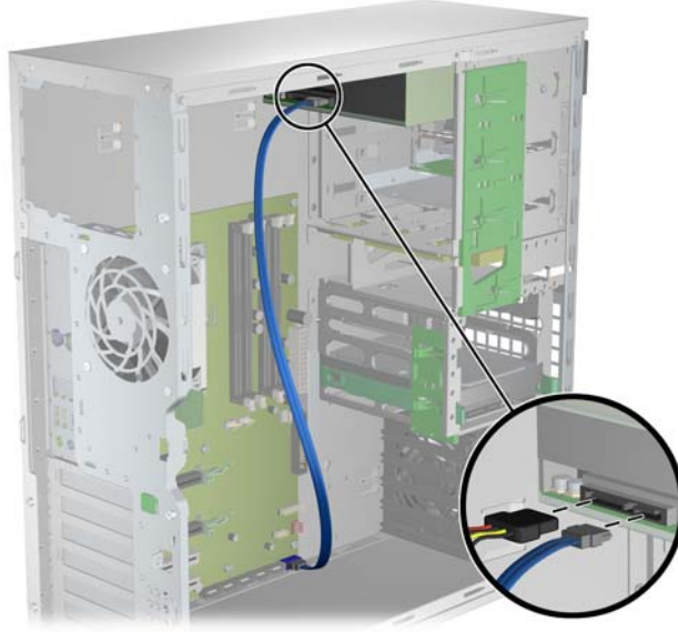
Şekil 10-2 ODD güç ve veri kablolarını bağlama
