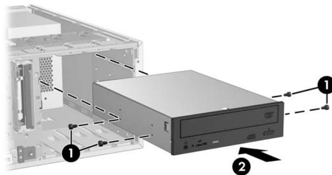
4. ネジをドライブベイの溝に合わせて、ドライブが正しい位置に固定されるまで、ドライブをゆっくりとベイに挿入します (2)。
