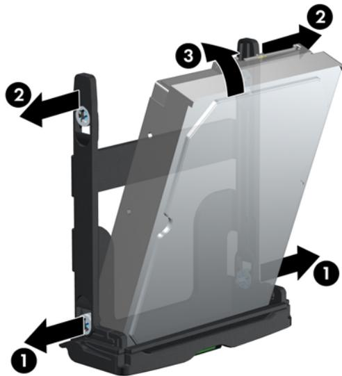
4. 上の図に示すように、上部の 2 本のハードディスク ドライブ キャリア レールをゆっくりと開き (2)、ドライブを回転させて垂直にします (3)。
