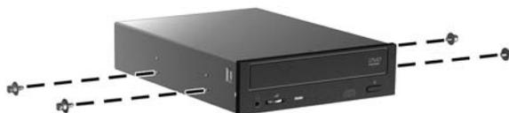
4. ネジをドライブベイの溝に合わせて、緑色のドライブロック リリース レバーを持ち上げながら、ドライブをゆっくりとベイに挿入します。ドライブの一部が挿入されたらドライブロック リリース レバーを放し、ドライブが正しい位置に固定されるまでドライブを完全にベイに挿入します。
