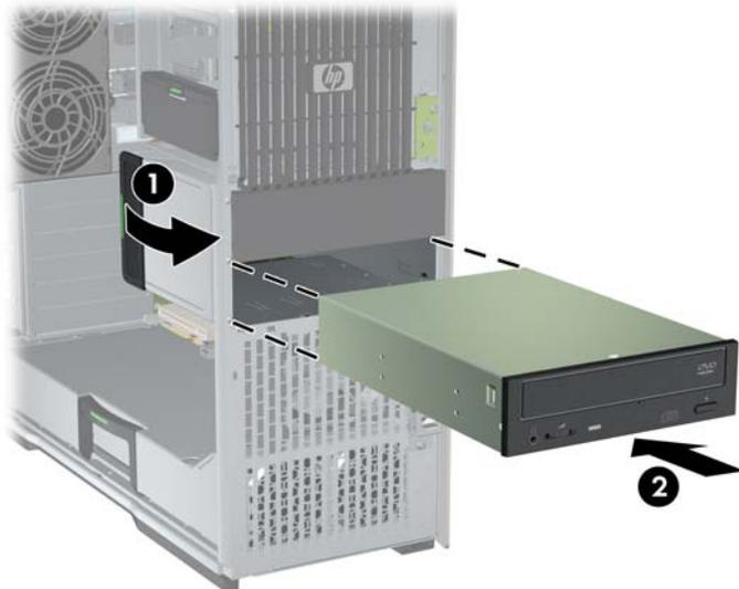
4. 以下の図に示すように、電源ケーブルとデータ ケーブルをオプティカル ディスク ドライブに接続します（図の例は HP Z600 ワークステーション）。
