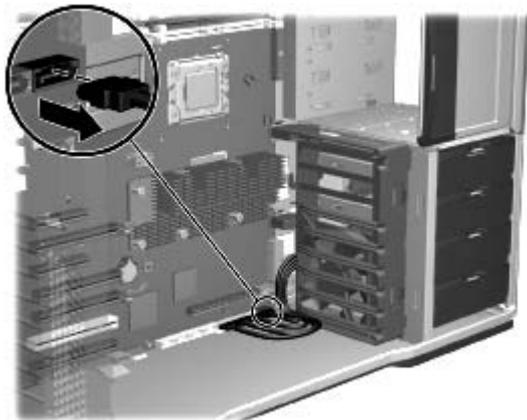
図 2 ブラインドメイト ハード ドライブ ケーブルを Mini-SAS 4i アダプタ ケーブルに接続します
