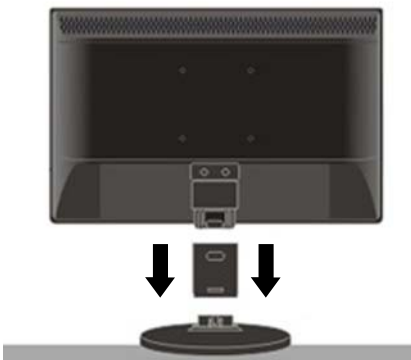
Gambar 3-1 Memasang Monitor pada Alas Dudukan
