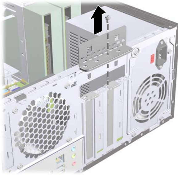
Figure 2-9 Ouverture des obturateurs d'extension
