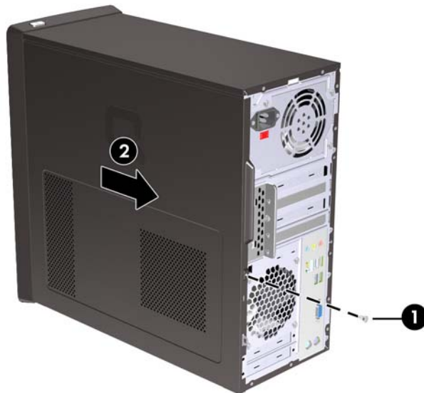
Figure 2-1 Retrait du panneau d'accès de l'ordinateur
