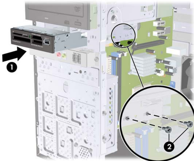
Figure 2-25 Installation d'un périphérique 3,5 pouces (lecteur de carte multimédia illustré)
