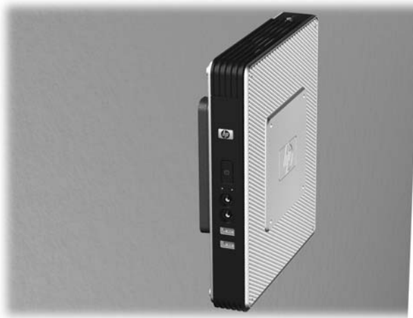
Abbildung C-7 An der Wand montierter Thin Client
