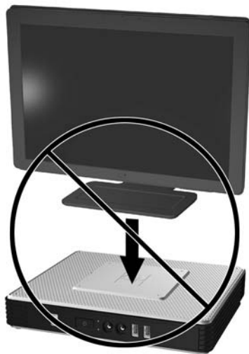
Abbildung D-5 Stellen Sie keinen Monitor auf den Thin Client
