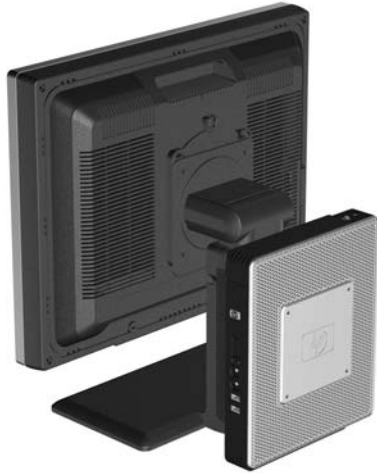
Abbildung C-6 An der Rückseite eines Monitorstandfußes montierter Thin Client
