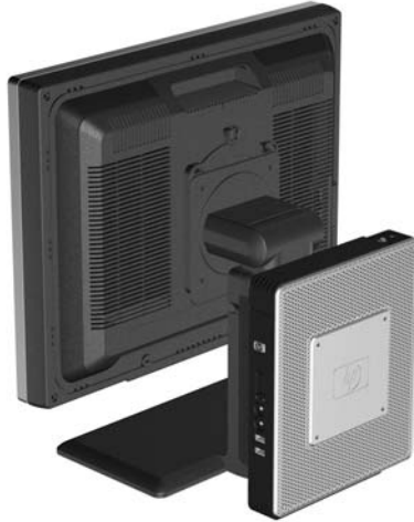
Figura C-6 Thin Client montada en la parte trasera de la base del monitor
