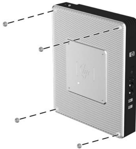
Figura 1-6 Instalación de los soportes de goma
