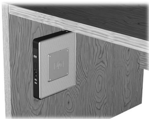
图 C-8 安装在桌子下面的瘦客户机
