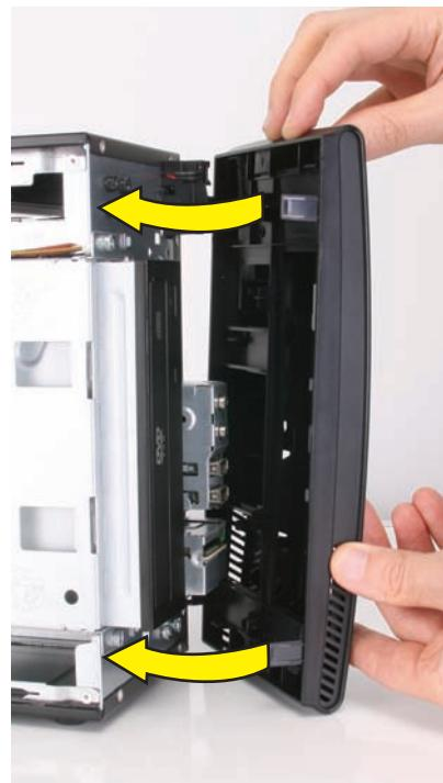
**13** Alinee las lengüetas del borde interior del panel lateral izquierdo con las ranuras situadas en el borde del lateral izquierdo en la carcasa del equipo.
