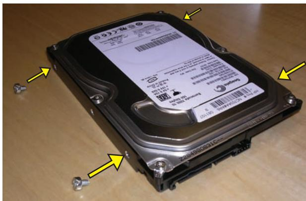
Cuando se instale adecuadamente, al sostener la unidad con la etiqueta (**A**) orientada hacia arriba y los conectores de datos y de alimentación (**B**) orientados hacia usted, los tornillos guía (**C**) estarán a su izquierda.
