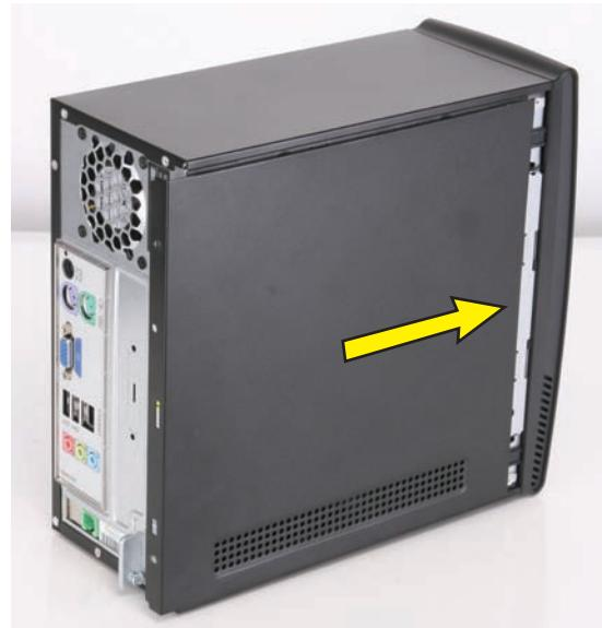
**10** Alinee las lengüetas del borde interior del panel lateral izquierdo con las ranuras situadas en el borde del lateral izquierdo en la carcasa del equipo.
