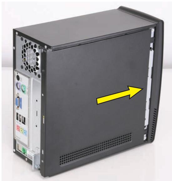
**15** Vuelva a colocar los tornillos que sujetan el panel lateral al equipo.
