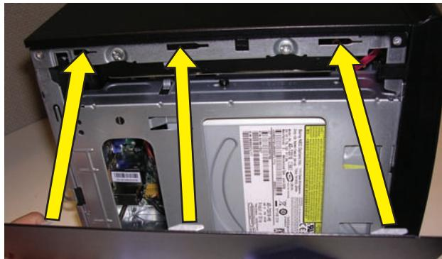
**12** Vuelva a colocar los tornillos que sujetan el panel lateral al equipo.
