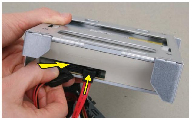
**NOTA:** La ubicación de las conexiones de cable puede variar según el modelo de unidad óptica en su equipo.
