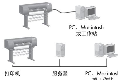
打印机可以直接连接到一台计算机，也可以通过网络连接到一台或多台计算机。
