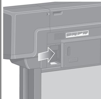
找到打印机后部的连接区域。从此区域，您可以将打印机连接至计算机或网络，也可以安装可选附件。
