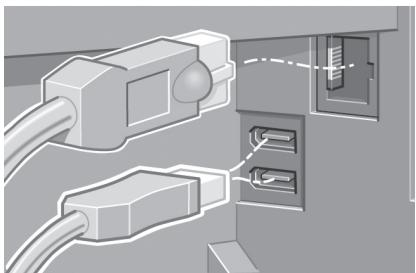
快速以太网插孔可以将打印机连接到网络。
