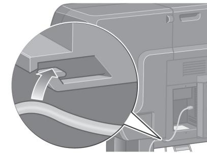
将 LAN 电缆穿过打印机后部的挂钩。
