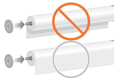
将打印机随附的卷筒纸张滑到卷轴上。确保纸张的方向完全如图所示。
