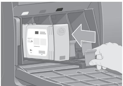
Vuelva a introducir el cajón en la impresora hasta que encaje perfectamente.
