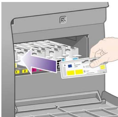
2. Una vez que haya introducido completamente el limpiador de cabezal de impresión, presiónelo hacia adentro y hacia abajo, como indica la flecha, hasta que emita un clic.
