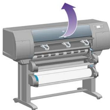
4. Levante la palanca de sujeción tanto como pueda.
