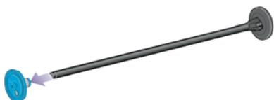
2. Si el diámetro del cilindro interior del rollo es de 7,62 cm (3 pulgadas), compruebe que se han instalado los adaptadores de cilindros suministrados con la impresora. Consulte a continuación:
