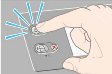
Quando você desliga a impressora dessa forma, os cabeçotes de impressão são automaticamente armazenados com os dispositivos de limpeza, o que previne que eles sequem.
