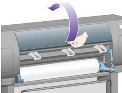
3. Com uma escova seca, remova os depósitos de tinta na ranhura do cortador
