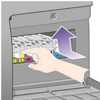
4. Levante o dispositivo de limpeza para removê-lo do slot e deslize-o horizontalmente como mostrado.
