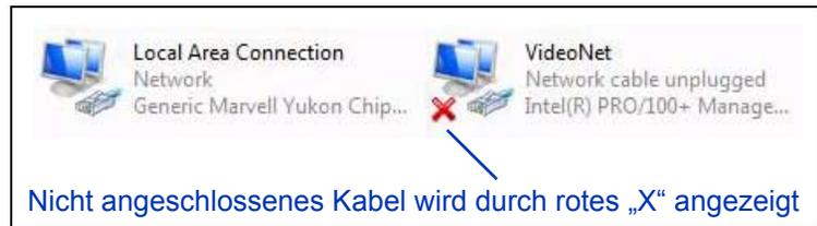
Abb. 1-1. Identifizieren der VideoNet-Verbindung
