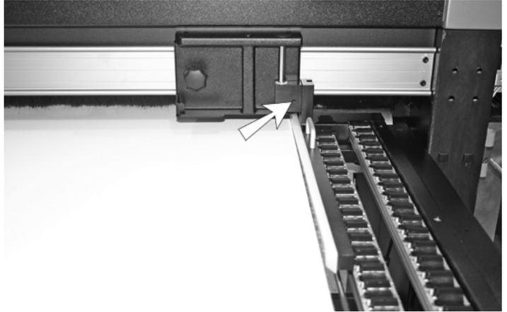
Abb. 2-12. Positionsschraube
