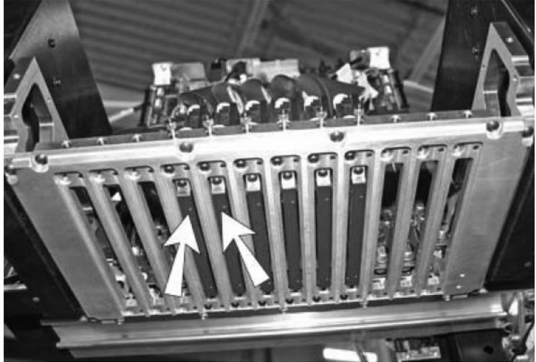
Abb. 4-10. Zentrieren Sie den Schlitten an diesen beiden Punkten über dem Wischer
