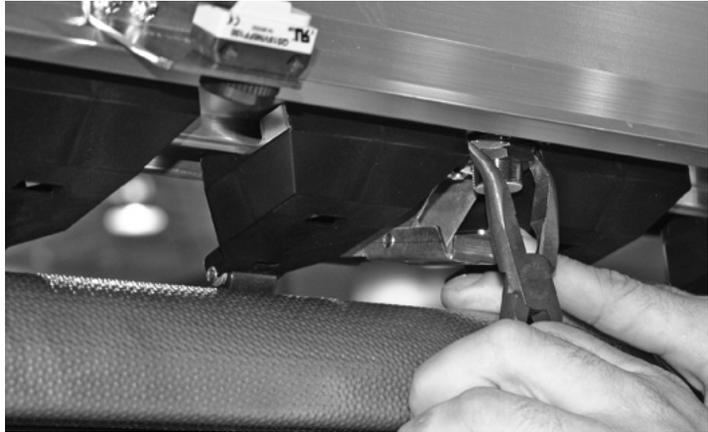
Abb. 4-8. Medienstärke-Sensor (Bürsten zur besseren Übersichtlichkeit entfernt, dieser Schritt ist nicht erforderlich)
