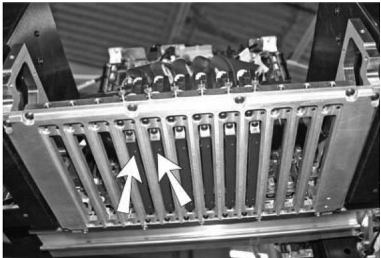
Fig. 4-10. Centre el carro en estos dos puntos por encima de los limpiadores
