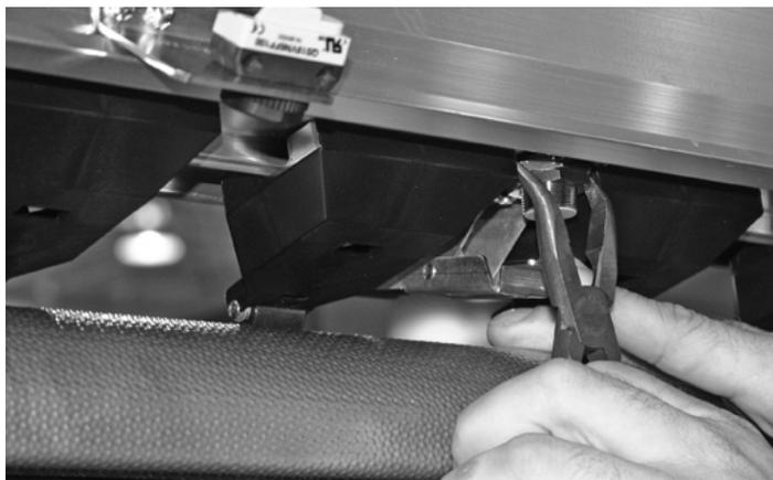
Fig. 4-8. Sensor de grosor de material de impresión (se han quitado las escobillas para que sea más claro el ejemplo, no es necesario realizar este procedimiento)
