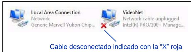
Fig. 1-1. Identificación de la conexión de VideoNet
