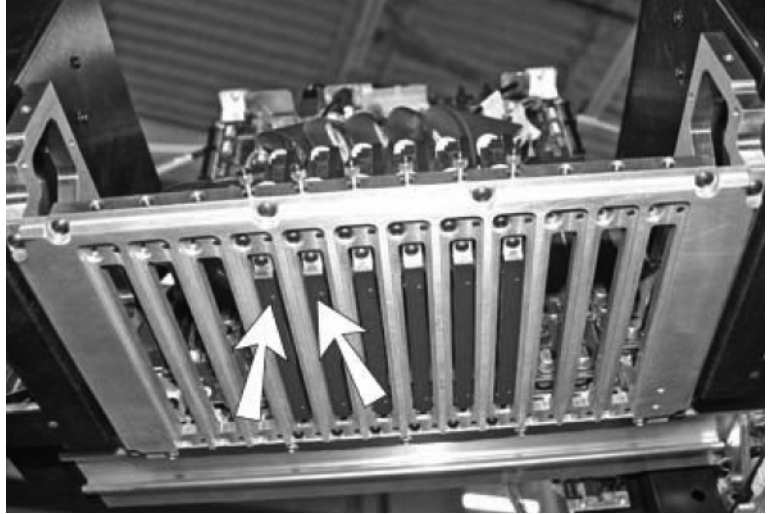
Fig. 4-10. Centrez le chariot au niveau de ces deux points au-dessus des essuyeurs
