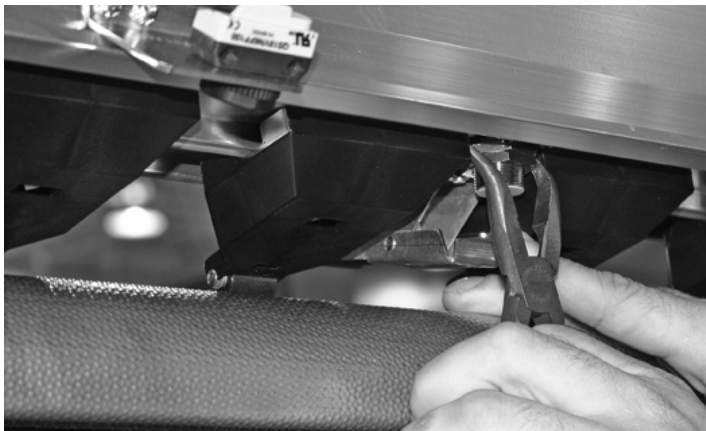
図 4-8. メディア厚さセンサ (明確さのためにブラシは取り除かれ
