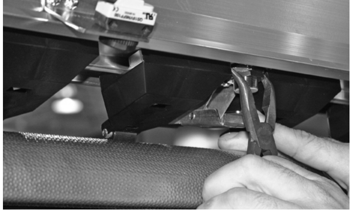
Şek. 4-8. Ortam kalınlığı sensörü (açıkça görülmesi için fırçalar çıkarılmıştır, yordamı uygulamak için çıkarmak gerekmez)
