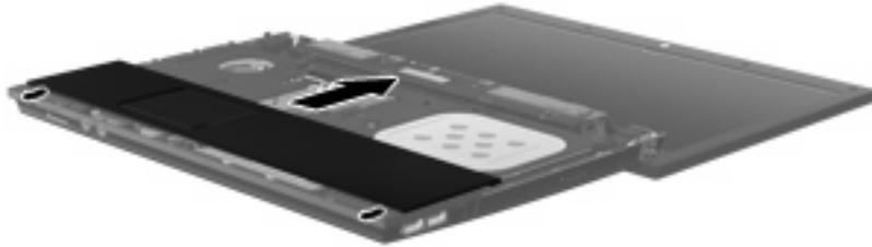
17. Libere el conector del ZIF (1) al cual está conectado el cable del TouchPad, y luego tire hacia arriba de éste (2) para desconectarlo de la placa del sistema.
