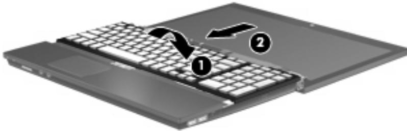
16. Bringen Sie die Schrauben an der Tastatur wieder an. Je nach Computermodell müssen Sie entweder 2 oder 3 Schrauben anbringen.
