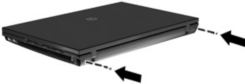
20. Bringen Sie die Schrauben im Akkufach wieder an. Je nach Computermodell müssen Sie entweder 2 oder 3 Schrauben anbringen.
