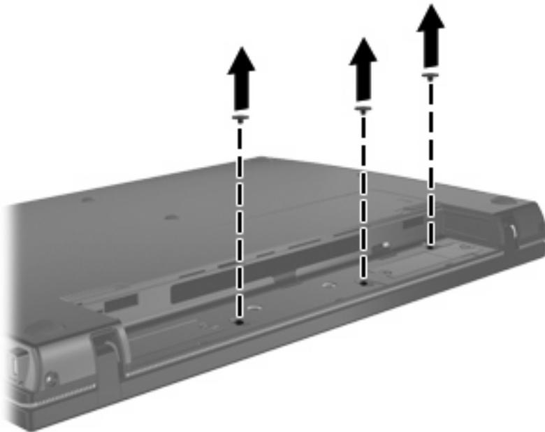
8. Drehen Sie den Computer mit dem Display nach oben, und entfernen Sie die beiden Schrauben von der Rückseite des Computers.
