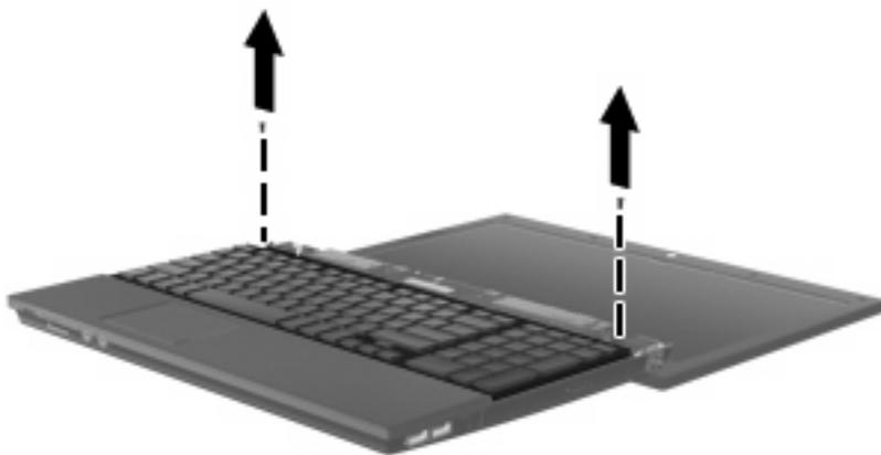
12. Schieben Sie die Tastatur (1) in Richtung Display, und kippen Sie sie dann mit ihrer Oberseite nach unten auf die Handablagefläche (2), um Zugang zum Speicherfach zu erhalten.
