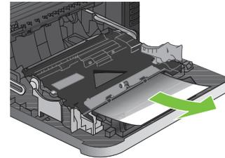
4 Levante la cubierta de alimentación de papel del interior de la puerta derecha. Si hay papel atascado, tire con cuidado de él en dirección horizontal para extraerlo.
