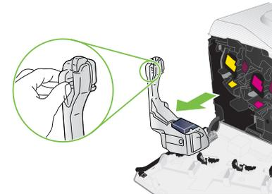
3 Coloque la tapa azul acoplada sobre la abertura azul situada en la parte superior de la unidad.
