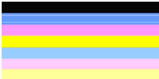
קווים לבנים על-גבי הפסים בדוח איכות הדפסה יש קווים לבנים.
