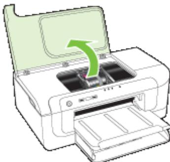
3. インク カートリッジをすべて取り外し、インク開口部を上に向けて紙の上に出します。
