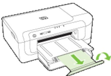
**注記** 279 mm (11 インチ) より長いメディアの場合は、拡張部を最大拡張位置まで引き出します。拡張トレイの端にあるフラップが持ち上がっていないことを確認します。フラップが持ち上がっていると、用紙の取り出しが妨げられます。
