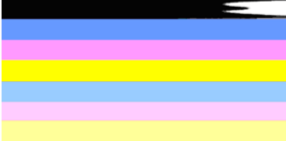
Kötü Renk Çubukları Örneği | Üst çubuk düzensiz olarak çizgili veya soluk.
