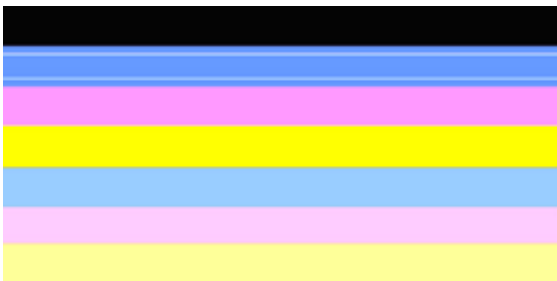
白色条纹 | 打印质量颜色条中有白色条纹。
