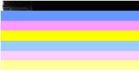
较差颜色条的示例 | 顶部黑色颜色条一端带有锯齿。
