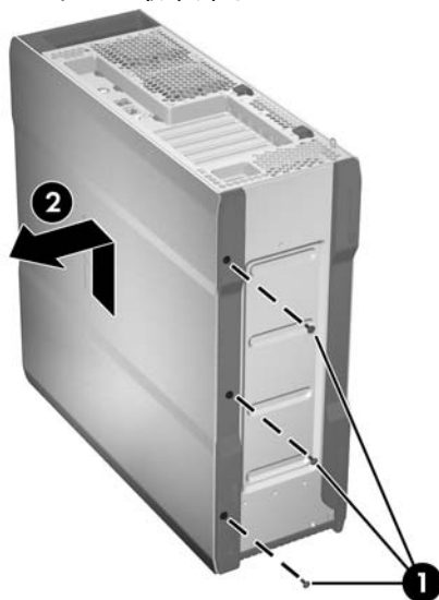
図 5-6 右サイドパネルの取り外し
