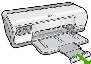
3. Wenn Sie im Modus "Entwurf (schnell)" drucken, klappen Sie den Anschlagbügel der Ausgabefachverlängerung nach oben.
