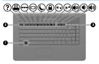
Die Symbole auf den Tasten f1 bis f9, f11 sowie f12 stehen für die Funktionen der fn-Tastenkombinationen. In den folgenden Abschnitten werden Anleitungen zur Verwendung dieser Funktionen gegeben.
